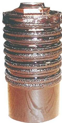
図II. 二次摩耗状態図 (5000~10000km走行時)
